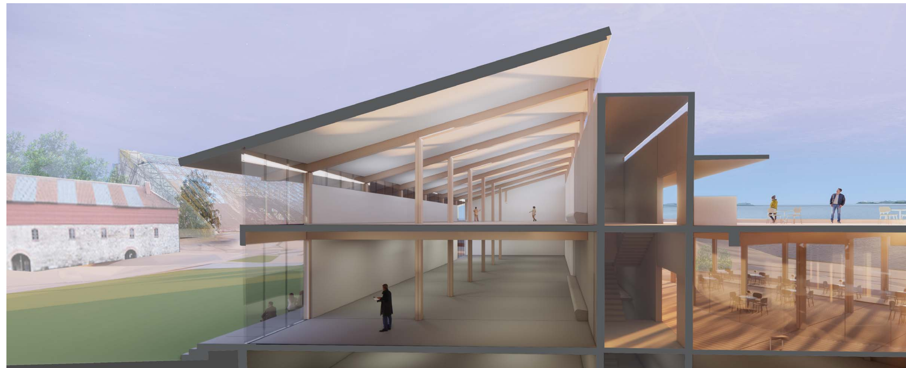
Perspektivsnitt gjennom utstillingsbygningen, kjerneområdet, takdekket og restauranten
