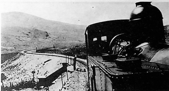
Snowdon Mountain Railway. På vei opp med lok nr.5 "Moel Siabod" (B 1-zzt-n-2, SLM, Wintertthur 1896)
