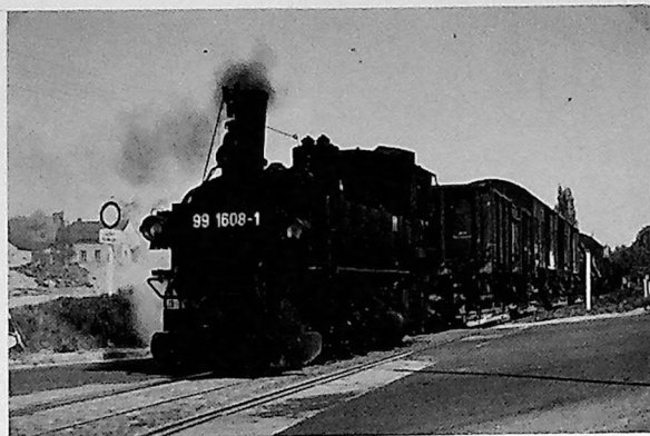
Et godstog til Mügeln trekker ut fra Oschatz med Meyer 99.1608-1. Merk Heberleinbremse- systemet ved skorsteinen og over loket.
