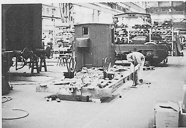
Rammen er sandblåst og geidene tilpasses. B. Halling brenner av bunntømningshengslar.
