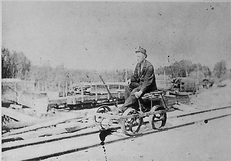
Anders Johnsen på pumpedressin ved Bingsfos i 1897. På sporet i bakgrunnen sees Urskogbanevogner fullastet med plank klare for omlasting til normalsporvogner. Arkiv UHB.
