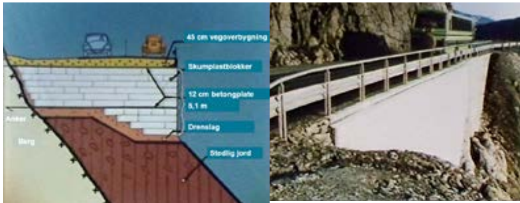
EPS-fylling med vertikal sideavslutning og forankring i berg, slik den ble bygd ved Rv 5 Stedjeberget i Sogn og Fjordane våren 1980. (Tegning av Arne Helland)
