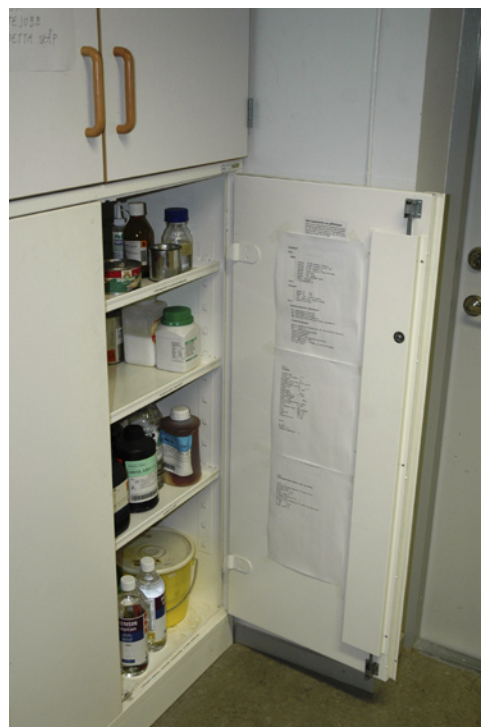
Brandfarliga vätskor måste förvaras i ett brandsäkert kemikalieskåp. Foto: Lisa Nilsen.
