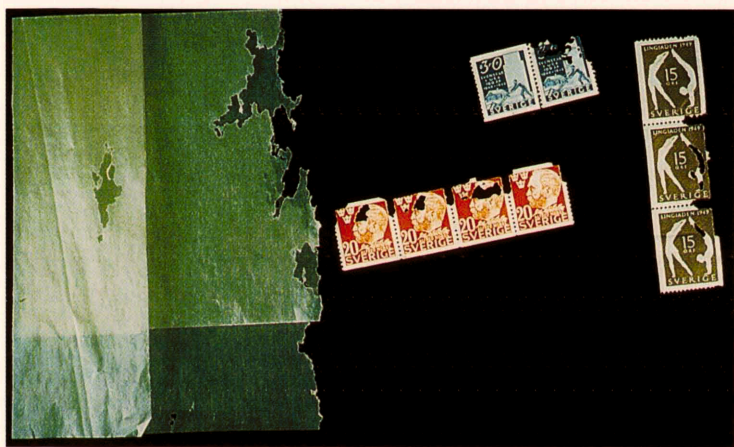
Frimärken förvarade i ett fuktigt bankvalv.
