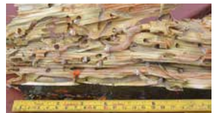
Stråkjølen til «Den Siste Viking II» var ny sist vår. Her har pælemarken gjort en grundig jobb på bare noen måneder! Heldigvis har vi takpapp mellom kjølen og stråkjølen, så det er bare stråkjølen som er berørt. Foto: Einar Borgfjord.
