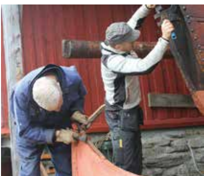
Behandling av rorbeslagene til «Den Siste Viking II». Foto: Tora Heide.
