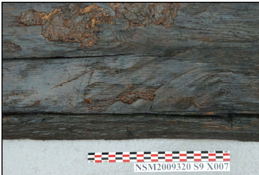
Figur 11 Utsiden av hudbord x007 med klare spor etter øks.
