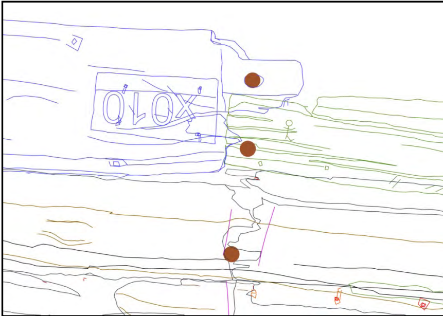
Figur 26 Overlapp mellom hudbord x009 (blå) og x008 (grønn). Reparasjon x010 (blå) er også på x009. Trenaglehull er illustrert med brune sirkler. To trenaglehull nærheten av hverandre vertikalt antyder at to band var festet sammen her.
