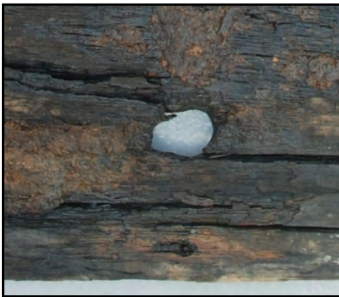
Figur 35 Hudbord x008 har et trenaglehull som kan være dobbelt.
