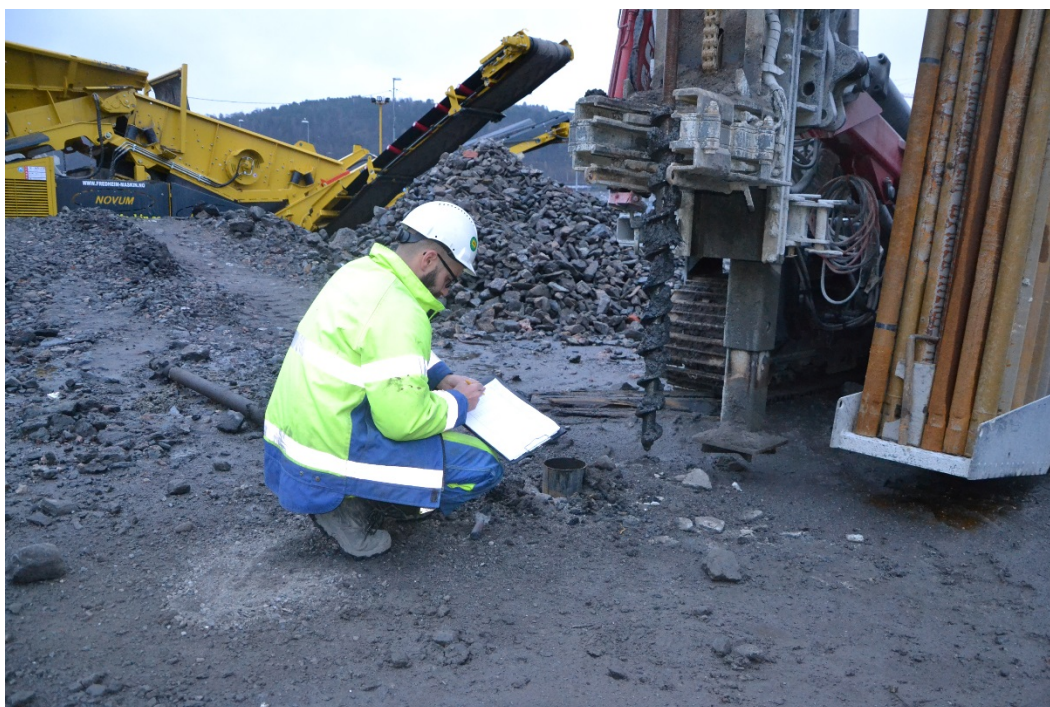
Figur 6: Khalil Olsen Holmen som dokumenterer borprøver fra forundersøkelsen på B1. Foto av Rune Borvik, NMM.
